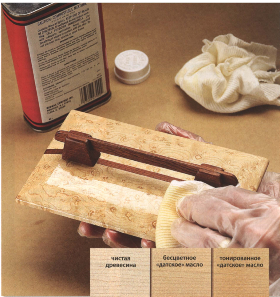
На этой кленовой доске можно увидеть теплый янтарный оттенок бесцветного «датского» масла и результат добавления пигментов.
