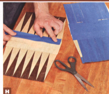
H Заклейте скотчем всю поверхность игрового поля. Избегайте наложения полос друг на друга, чтобы обеспечить равномерный прижим при наклейке набора на основу.
