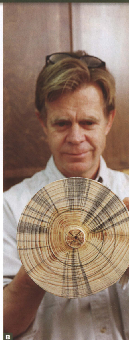
В Мэйси показывает результат выравнивания торцов с помощью отрезного резца. Заготовку можно крепить к планшайбе. Центральный выступ, если необходимо, нетрудно срезать стамеской.
