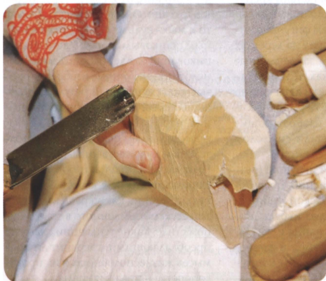
Прием работы стамеской: снятие большой массы дерева.
