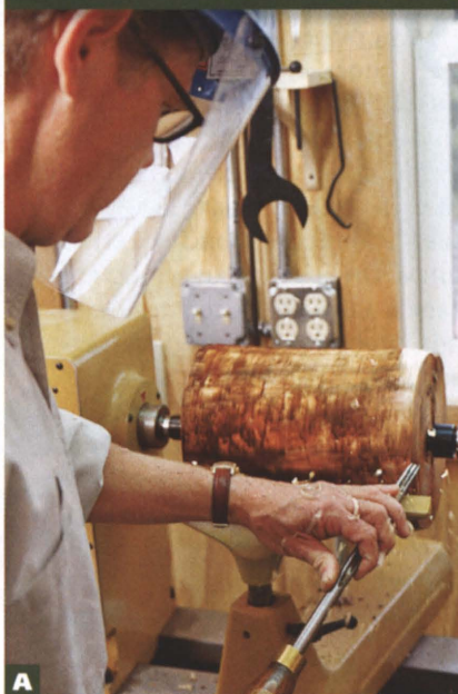
А Установив частоту вращения около 500 об/мин, подручник на 50 мм ниже оси точения, Мэйси обточил заготовку желобчатым резцом.
