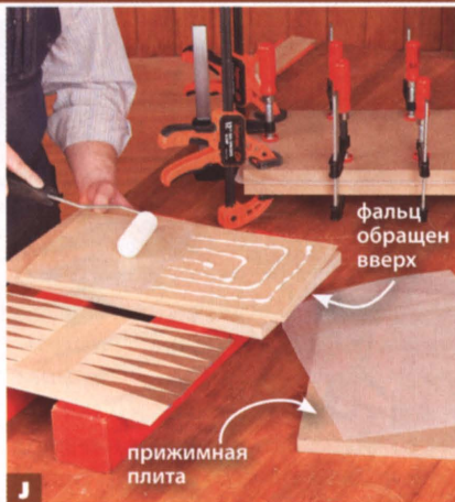
J Нанесите тонкий слой клея на основу. Для равномерного распределения прижимного давления используйте достаточное количество струбцин.
