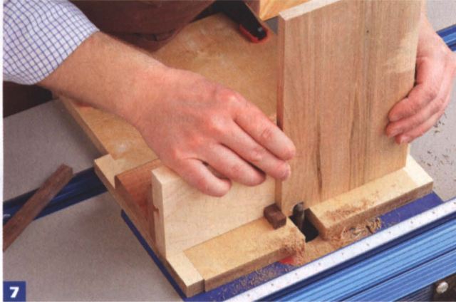
7 Для проверки настроек прижмите край пробной заготовки к штыревому упору. Сдвиньте салазки вперед, чтобы сделать в заготовке первую проушину.
