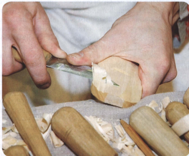
Прием работы богородским ножом: снятие тонкой стружки для окончательной обработки.
