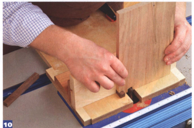
10 Прижмите угловой вырез к штыревому упору и сделайте второй проход. Последовательно сформируйте все шипы и проушины соединения. Опилите стенки ящика до окончательной ширины, удаляя неполные шипы.
