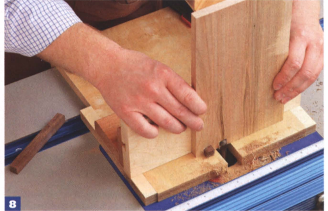
8 Наденьте первую проушину на штыревой упор и отфрезеруйте вторую проушину. Продолжайте операцию до завершения, каждый раз надевая новую проушину на штыревой упор.
