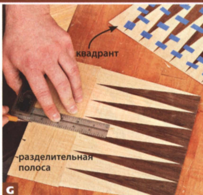
G Положите лист набора на край верстака и, выравнивая угольник с вершинами темных треугольников, поставьте метки на другом крае разделительной полосы.
