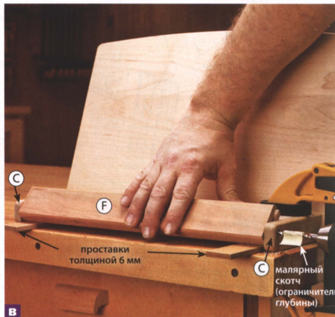
Просверлите отверстия диаметром 6 мм в торцах держателя F, плотно прижимая его к краю основания B.
