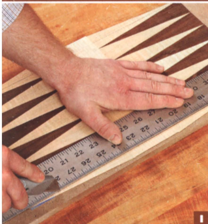
I Выверните край стальной линейки с вершинами внешних кленовых треугольников и острым ножом обрежьте игровое поле до окончательного размера.
