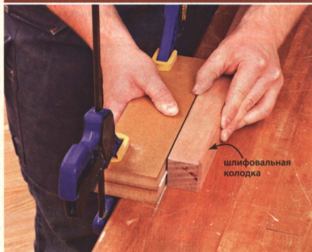
С помощью шлифовальной колодки придайте разделительной полосе из шпона окончательную ширину, сделав кромки параллельными и прямыми, чтобы между склеенными деталями не было зазоров.
