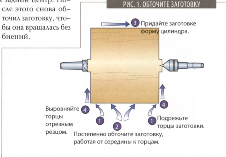
В Мэйси показывает результат выравнивания торцов с помощью отрезного резца. Заготовку можно крепить к планшайбе. Центральный выступ, если необходимо, нетрудно срезать стамеской.
