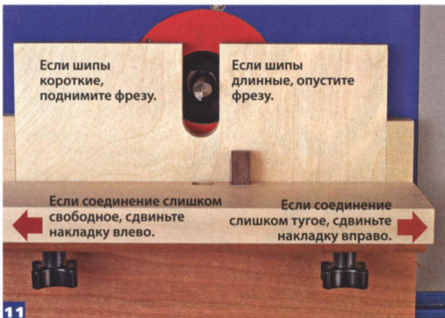
11 Проведите пробную сборку соединения. Оно должно легко соединяться усилием рук, но не разъединяться под собственной массой. Если требуется, измените настройки.
