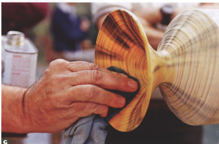
G Масляная пропитка готовой чаши делает ее еще лучше, усиливая контраст между темными и светлыми участками и добавляя янтарный оттенок.
